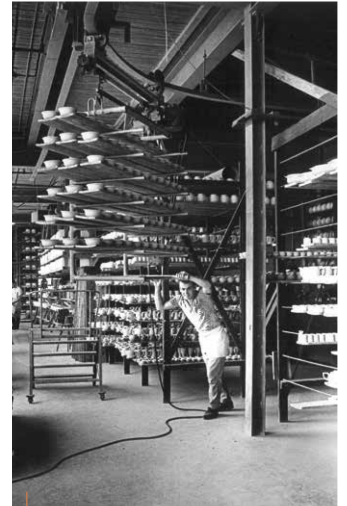
INTÉRIEUR DE L'USINE VANDESCA : étape du séchage de la production. Source : Coll. privée.
