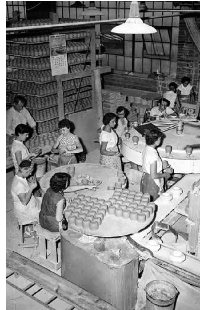
INTÉRIEUR DE L'USINE VANDESCA : étape de la pression de la pâte destinée à la fabrication de bols. Source : Société d'histoire de Joliette - De Lanaudière.
